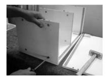
6 SLIDE THE REAR PANEL INTO THE GROOVE
